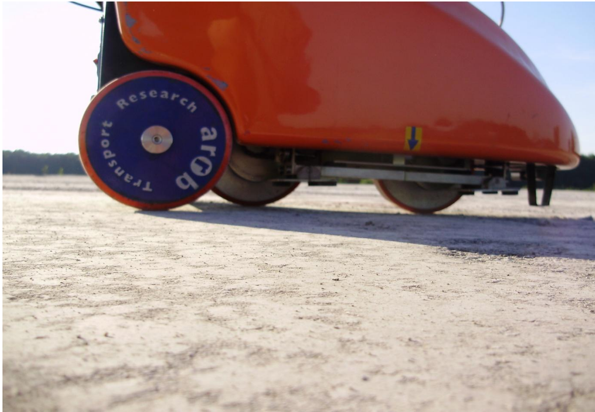
Slika 10. Izvođačka kontrola ravnosti izvedenog nosivog reciklažnog sloja
